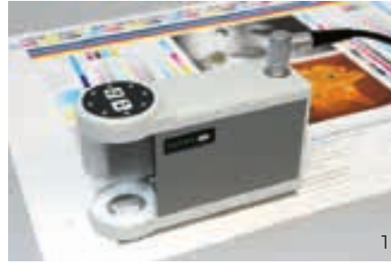
1 Passer-Messsystem LUCHS IV: Handmesskopf mit Verbindung über USB zum Laptop.
