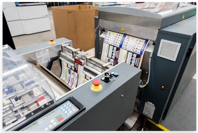
DETAIL OF THE TECNAU CUTREADY SOLUTION LOOSE WEB EXITING THE UNWINDER AND ENTERING THE CUTTER MODULE.
