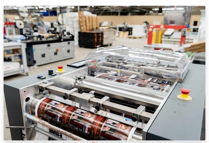
■ DETAIL OF THE TECNAU CUTREADY SOLUTION GUILLOTINE CUTTER MODULE.
