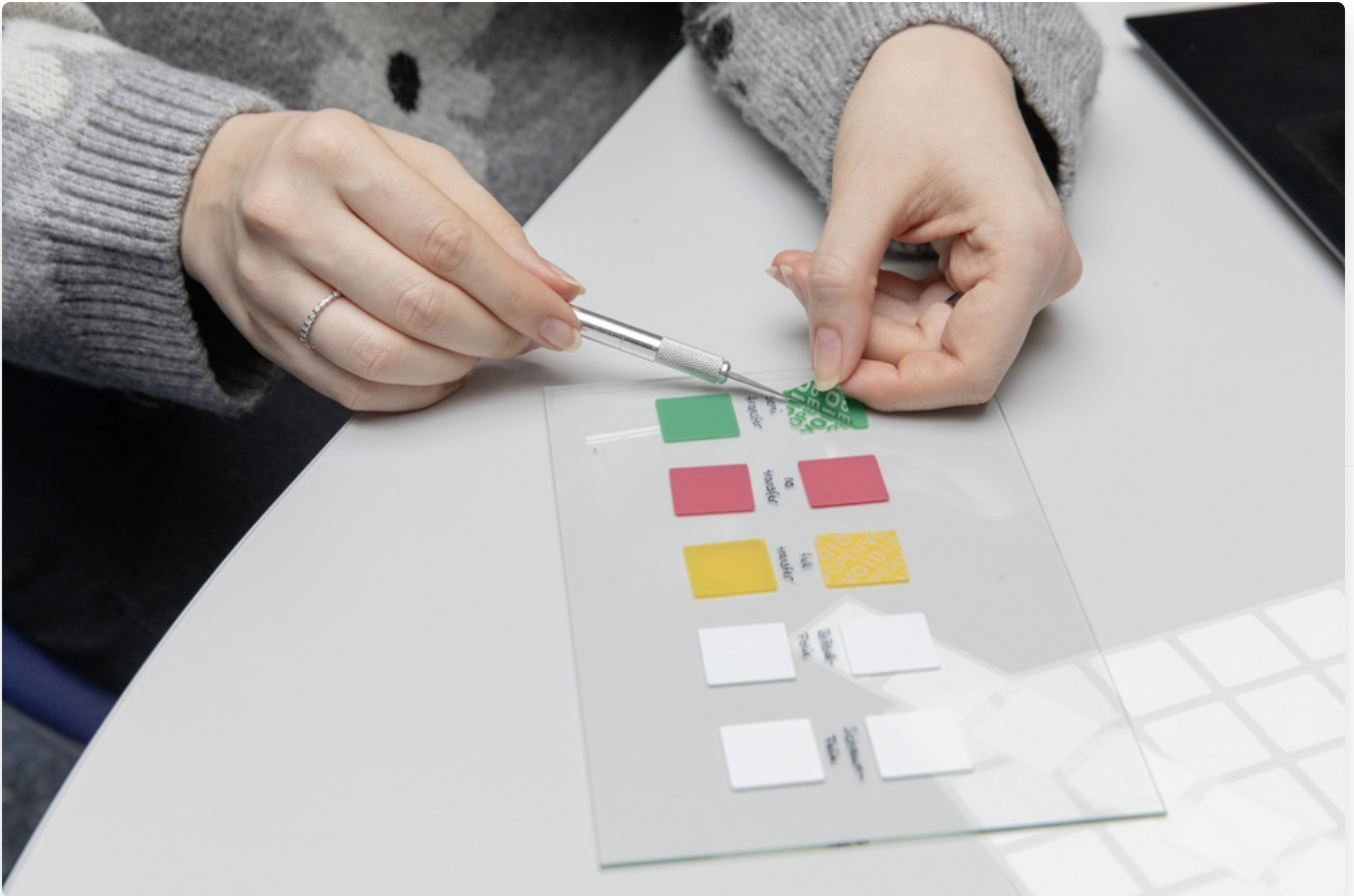
TAMPER-EVIDENCE-LÖSUNGEN: VOIDEFFEKT UND BRÖSELFOLIE.
