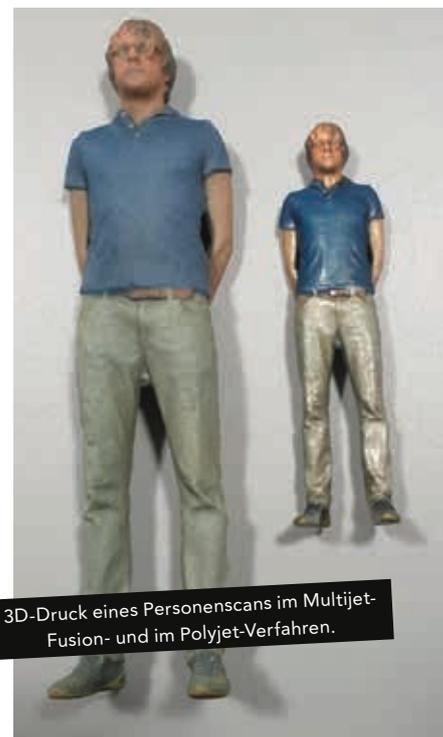
3D-Druck eines Personenscans im Multijet-Fusion- und im Polyjet-Verfahren.
