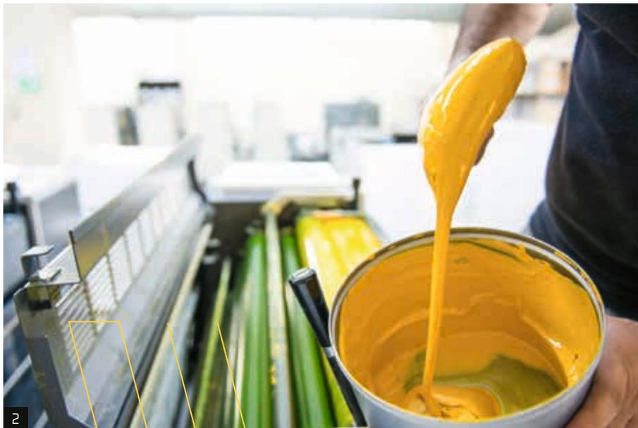
1+2 Die LED-UV-Farbserien sind auf die Wellenlängenbereiche 385 und 395 nm sowie auf H-UV-Anwendungen abgestimmt.
