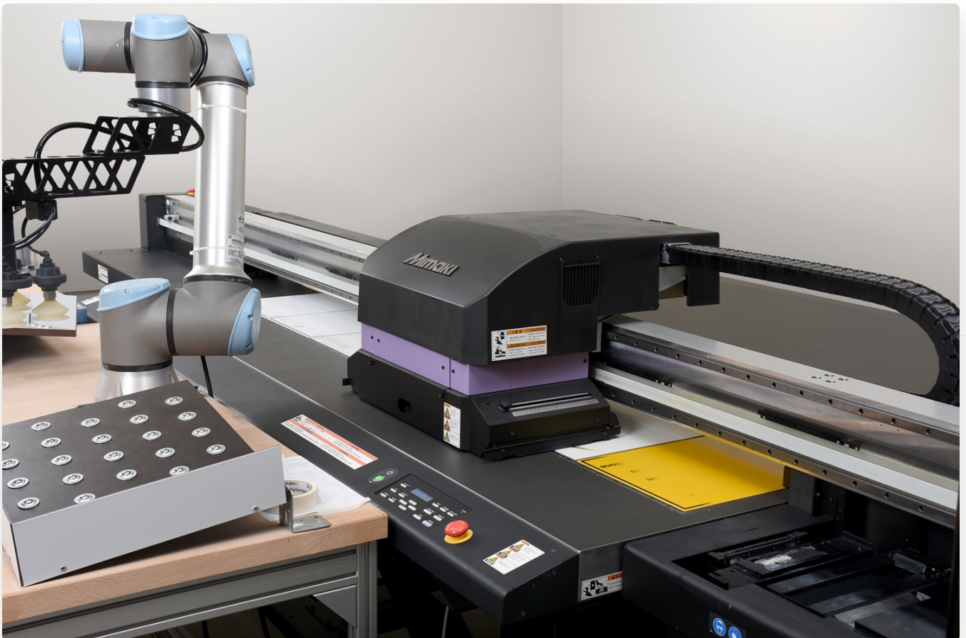
DER UV-PLOTTER BEDRUCKT DIE PLATTEN IM 4C-DRUCK MIT DEN VORGEBENEN MOTIVEN. IM ANSCHLUSS RÄUMT DER ROBOTER DIESE WIEDER AB.
