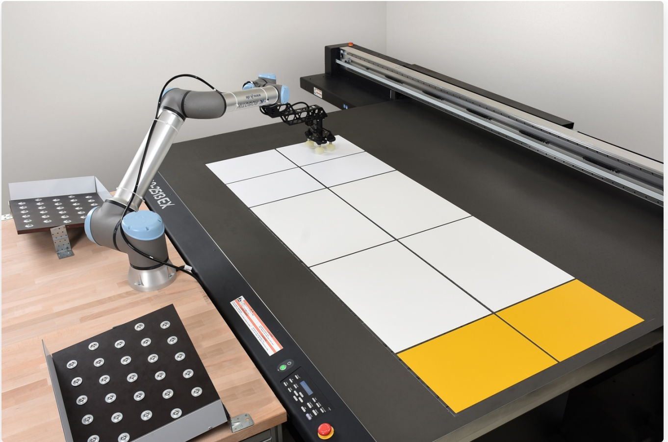
DER ROBOTER LEGT DIE EINZELNEN ROHPLATTEN AUF DEN DRUCKTISCH DES UV-PLATTENDRUCKERS FÜR DEN ANSCHLIESSENDE 4C-DRUCK.
