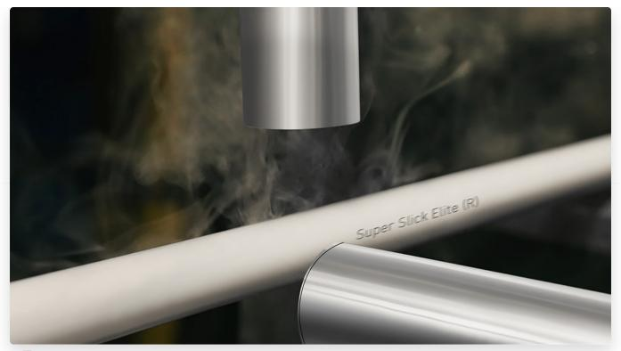
ENCORE WIRE MARKS A WIDE VARIETY OF CABLES AT ITS FACILITY IN TEXAS. THE LEIBINGER JET RAPID CAN MARK CABLES AT SPEEDS OF UP TO 3,280 FT/MIN.
